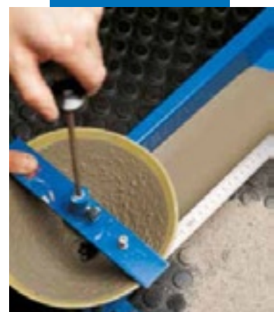
Испытание расширения в канавке согласно норме UNI 8997/89
