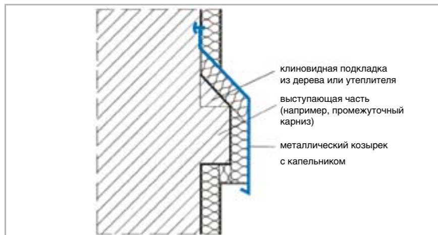
П. 2 – Вертикальный разрез выступающего элемента
