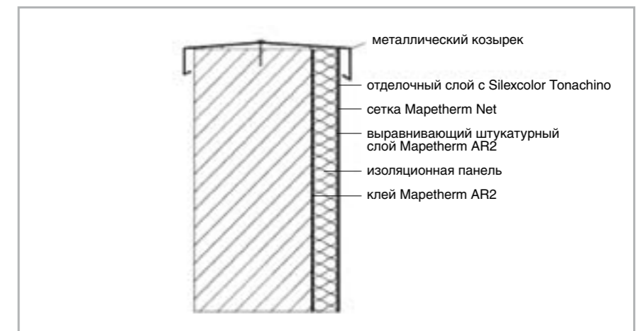
П. 18 – Верхняя часть перил, расположенных у краев плоской крыши
