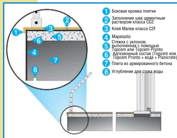
Фрагмент: гидроизоляция передней части балкона
