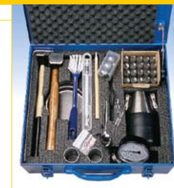
Инструмент для измерения содержания остаточной влажности в стяжках, действующий на основе химической реакции. Вода вступает в реакцию с карбидом кальция и образует газ ацетилен, который увеличивает давление. Уровень влажности определяется давлением, которое показывает манометр. Гидрометр поставляется в пластиковом футляре, который содержит: — стальной контейнер с ограничителем и манометром; — 20 стеклянных пробирок, содержащих карбид кальция; — 2 алюминиевых шарика; — 1 весы с опорой, чашу весов и грузы по 20 и 10 грамм; — 1 шприц; — 1 ложку и 1 стальную пластину. В наличии также имеются коробки с 20 пробирками карбида кальция.
