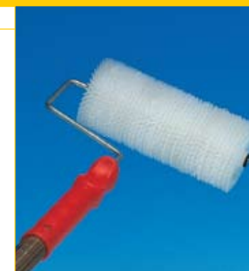
Пластиковый валик с ручкой (ширина 23 см, диаметр 8 см). Используется для улучшенного нанесения выравнивающих составов с толщиной слоя от 2 до 15 мм, помогает избежать образования пузырьков воздуха и улучшить внешний вид поверхностей, образованных с помощью самовыравнивающихся составов производства MAPEI.
